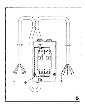
Impianto elettrico utente a 5 fili (Neutro distribuito) • Electric system for 5 wires user (distribuited neutral) • Installation électrique utilisateur à 5 fils (neutre distribué) • Elektrische Anlage Benutzer, fünfpolig (neutralen Pol) • Instalación eléctrico usuario a 5 cables (Neutro distribuido)
