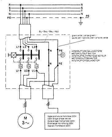
Impianto elettrico utente a 4 fili (Neutro NON distribuito) • Electric system for 4 wires user (NON distribuited neutral) • Installation électrique utilisateur à 4 fils (neutre NON distribué) • Elektrische Anlage Benutzer, vierpolig (OHNE neutralen Pol) • Instalación eléctrico usuario a 4 cables (Neutro NO distribuido)
